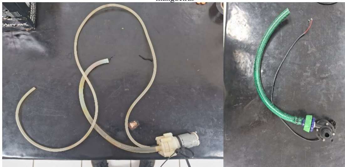
Figuras 9.a (esquerda) e 9.b (direita) – Bombas de consumo (esquerda) e da caixa d'água (direita) com mangueiras
