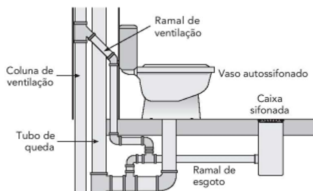
Figura 3. Corte de uma instalação de esgoto. (JÚNIOR, 2017) [6]
