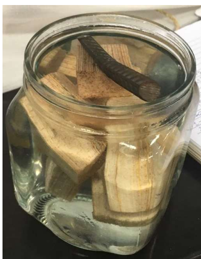
Figura 20-Corpos de prova imersos em água para ensaio de absorção.
