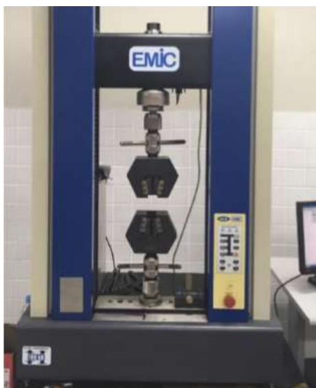
Figura 21- Garra da máquina preparada para ensaio de tração.
