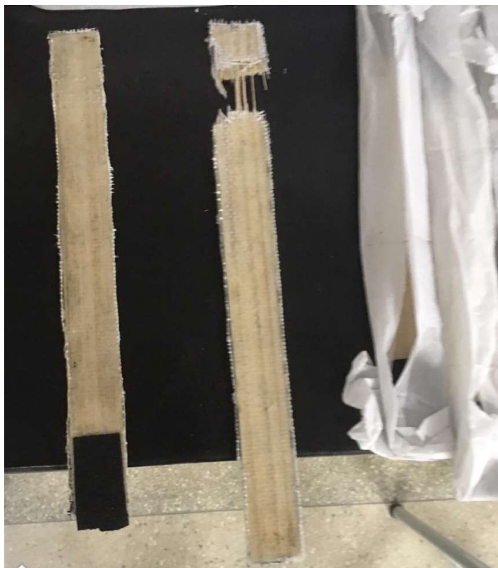
Figura 26- Corpos de prova falhados por esmagamento ou escorregamento.
