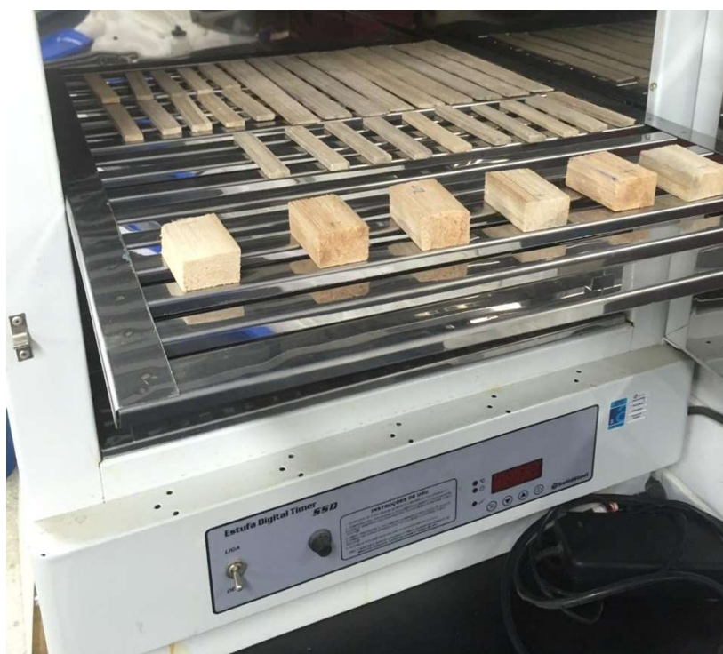
Figura 19- Corpos de prova de ensaio de tração, flexão e umidade na estufa.
