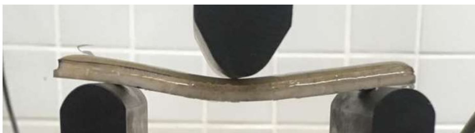
Figura 27- Primeira etapa da flexão do compósito CP1.
