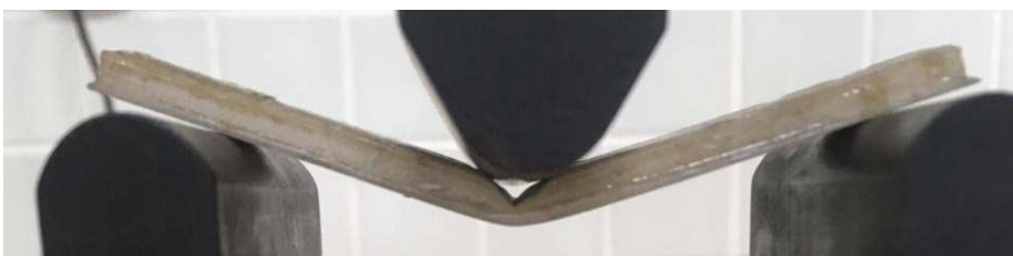
Figura 28- Segunda etapa da flexão do compósito CP1 (esmagamento).
