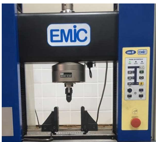
Figura 22 -Garra da máquina preparada para ensaio de flexão.
