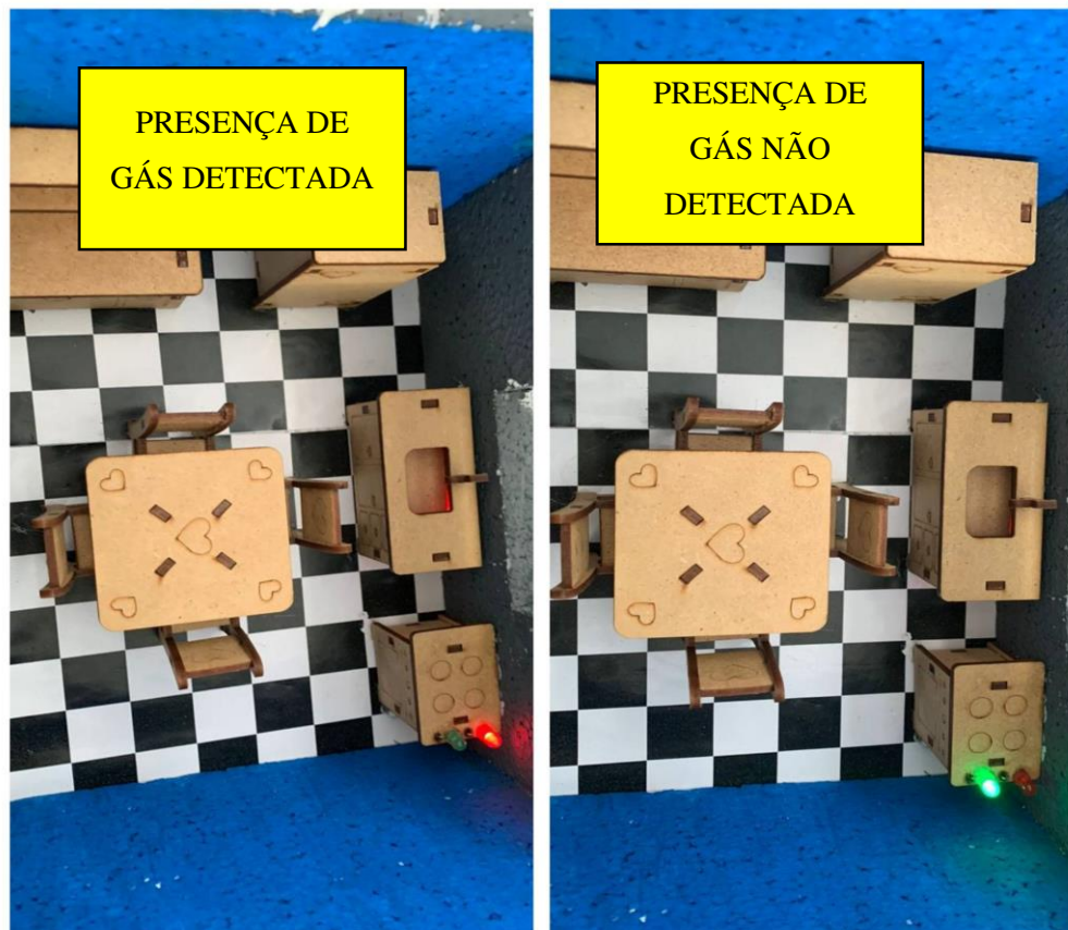
Figura 24: Funcionamento do sistema de detecção de gás de cozinha.
