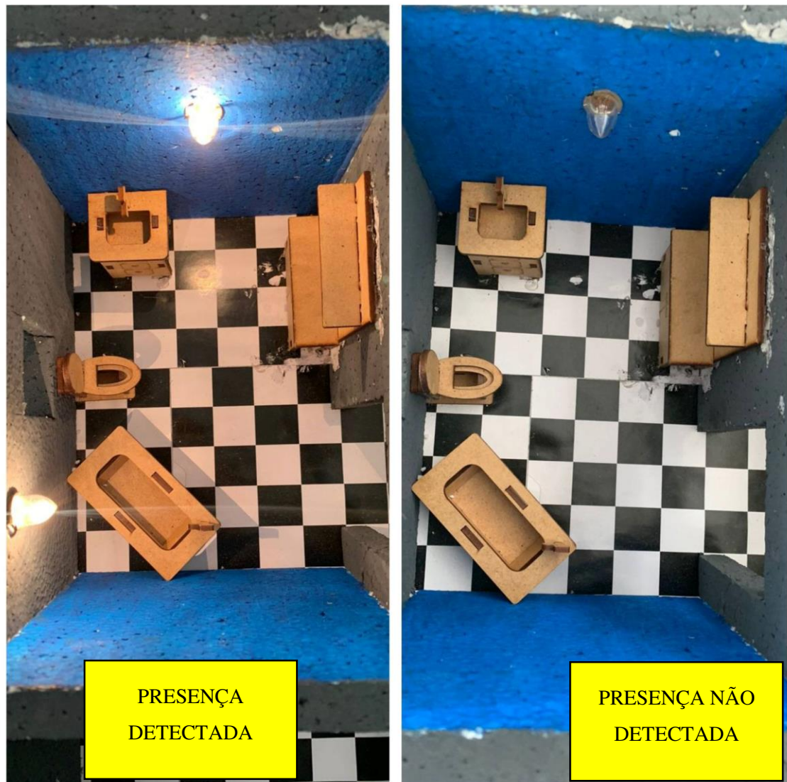
Figura 23: Funcionamento das lâmpadas do banheiro .
