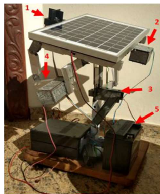
Figura 8. Rastreador do tipo eixo duplo desenvolvido por Renostro [13].
