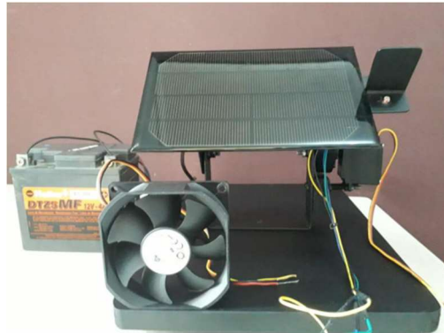
Figura 7. Rastreador do tipo eixo único horizontal desenvolvido por Bessa Neto [12].
