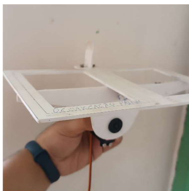
Figura 11. Estrutura das células, motor e LDR's montada. (Autoria própria)
