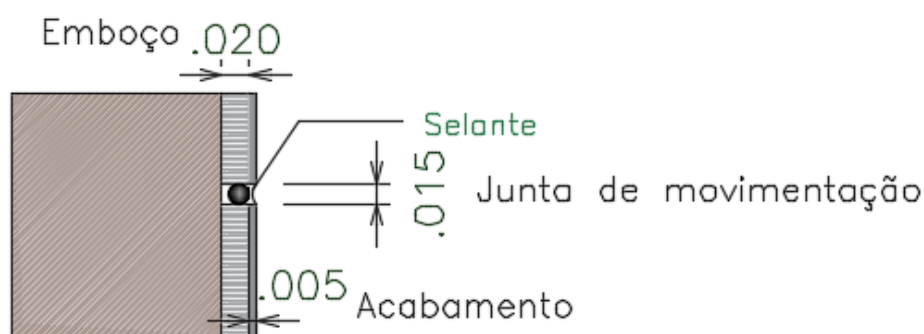
Figura 39: Detalhamento das Juntas verticais e horizontais
