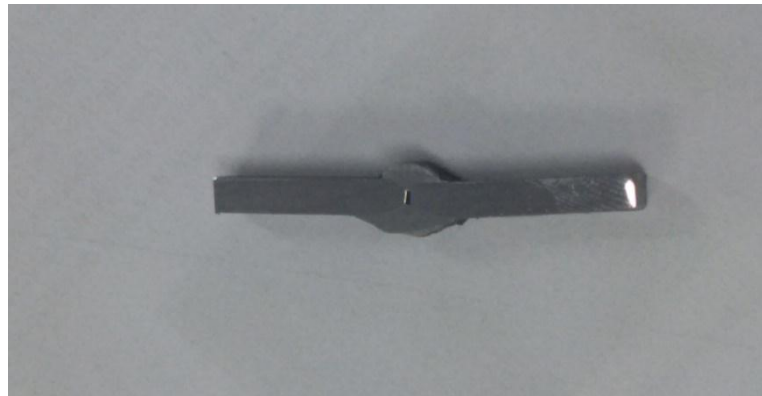
Figura 12: Amostra 1 do aço inoxidável 316 submetido a tratamento térmico de 100h e a corroída em solução concentrada de ácido nítrico.
