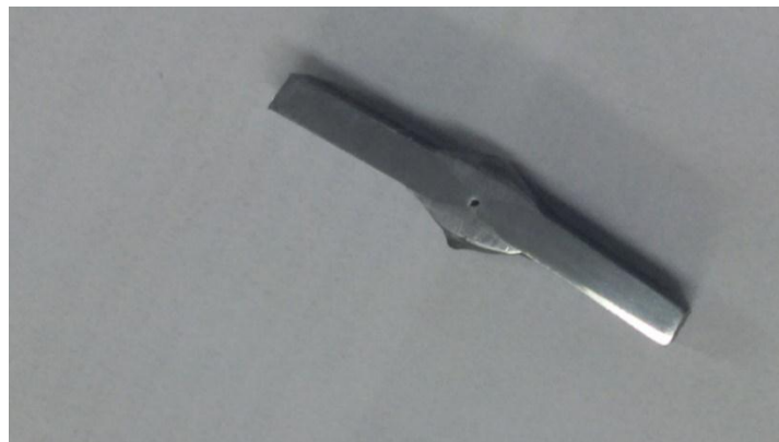
Figura 13: Amostra 2 do aço inoxidável 316 submetido a tratamento térmico de 1h e a corroída em solução concentrada de ácido nítrico.
