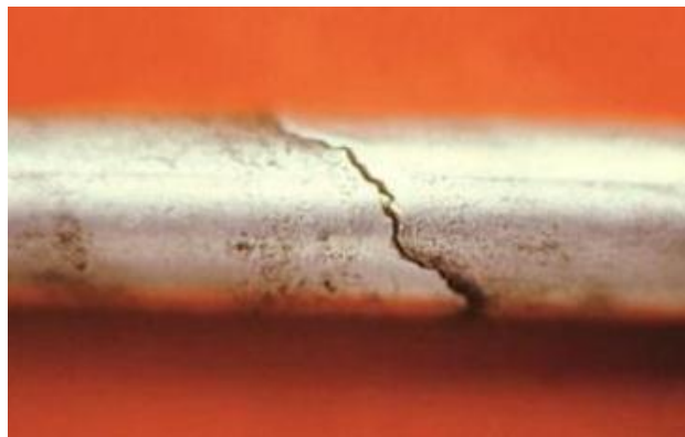
Figura 8: Corrosão sob tensão fraturante em tubo de aço inoxidável AISI 304.
