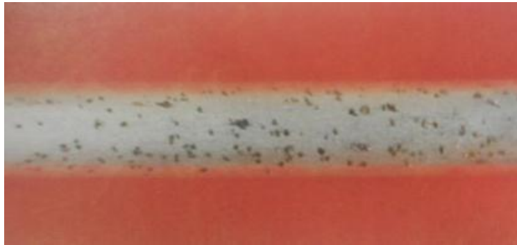
Figura 7: Corrosão por pite em tubo de aço inoxidável AISI 304.
