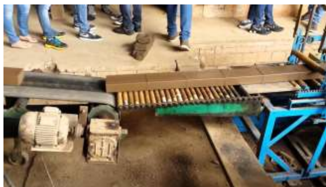
Figura 2.6 Corte do tijolo após a extrusão.
