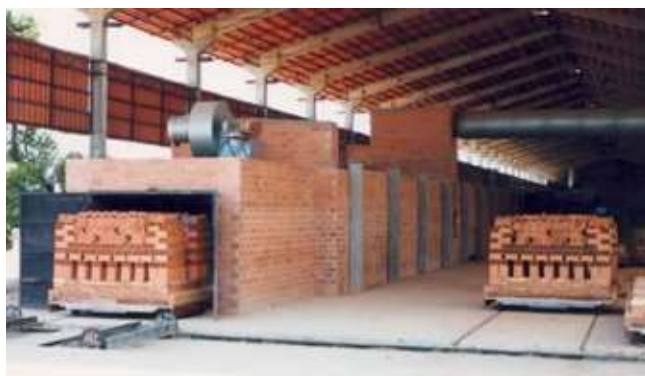
Figura 2.9 Forno túnel para queima de telhas e tijolos.
