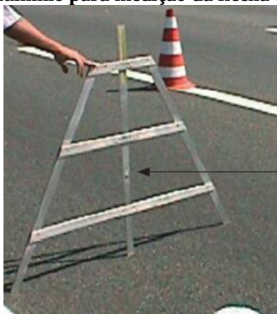
Figura 4 – Treliça de alumínio para medição da flecha da trilha de roda
