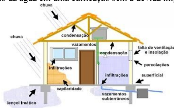
Figura 9 - Ação da água em uma edificação sem a devida impermeabilização
