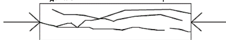
Figura 3 - Fissura devido a compressão
