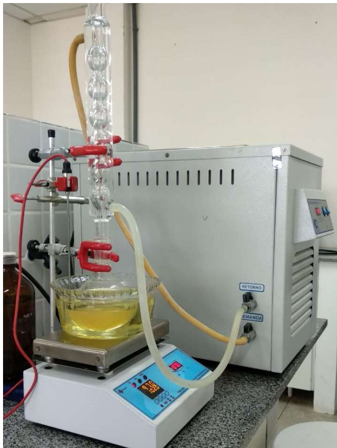
Figura 4: Sistema de refluxo para desacetilação da quitina.
