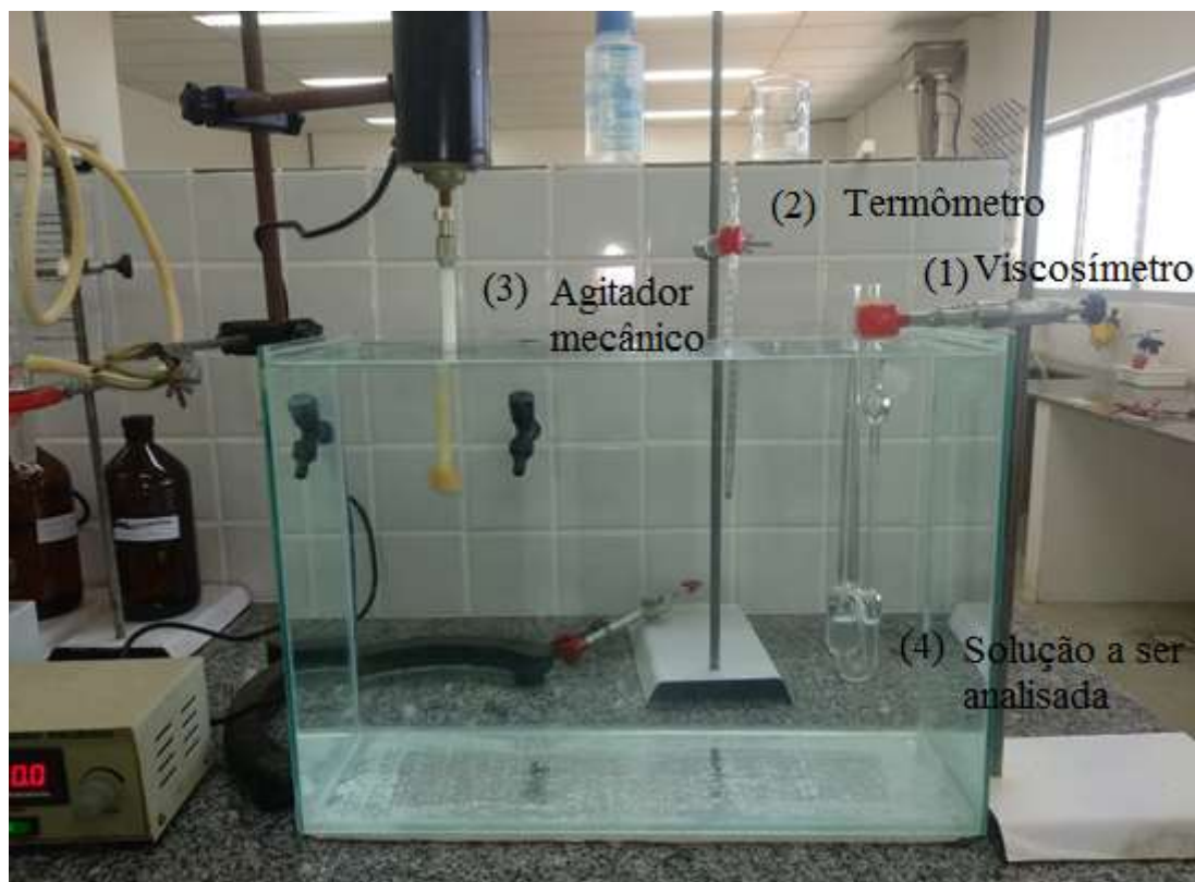
Figura 7: Esquema de execução da técnica de viscosimetria capilar
