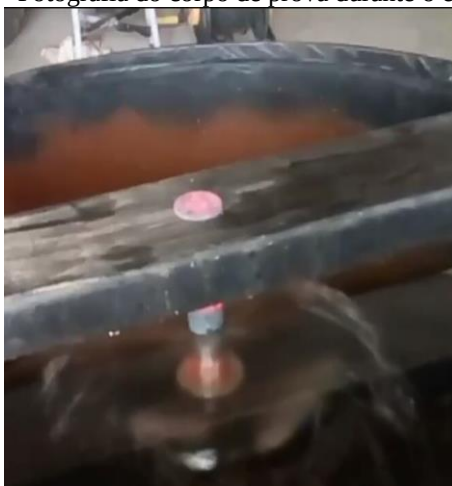
Figura 5 – Fotografia do corpo de prova durante o ensaio Jominy.
