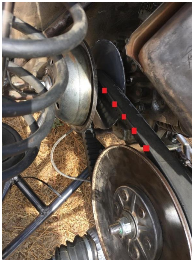
Figura 25 - Locais de medições na correia
