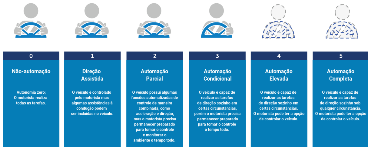
Figura 10 - Representação dos níveis de automação dos carros.
