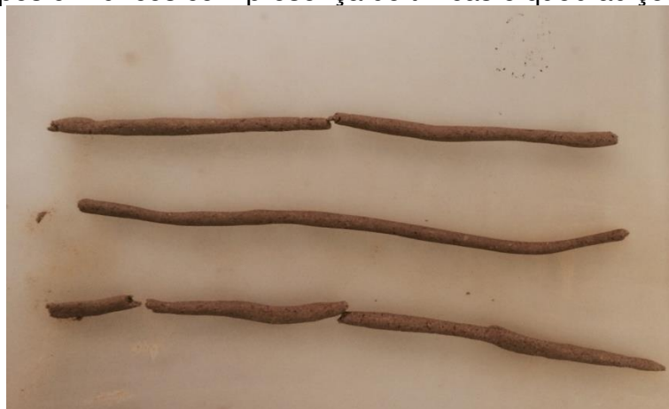
Figura 11 - Corpos cilíndricos com presença de trincas e quebradiços.
