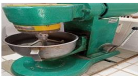
Figura 8 - Mistura na argamassadeira planetária
