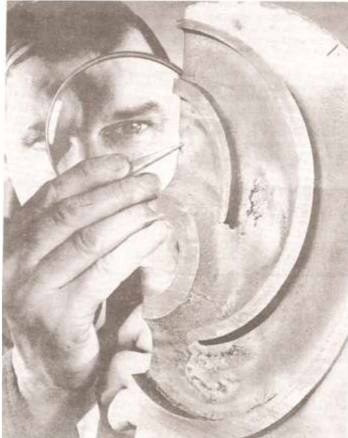
Figura 10: Efeito da cavitação em um rotor de bomba
