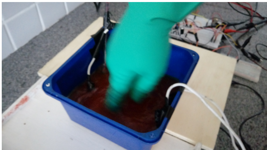
Figura 22: Solução corrosiva em contato com a resistência.
