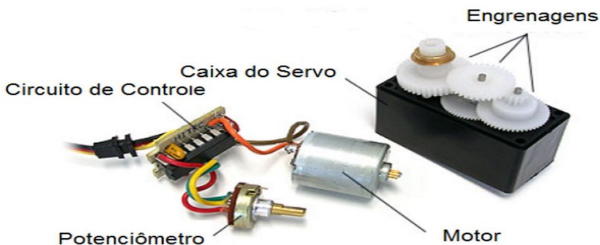
Figura 10: Componentes internos do Servo Motor.
