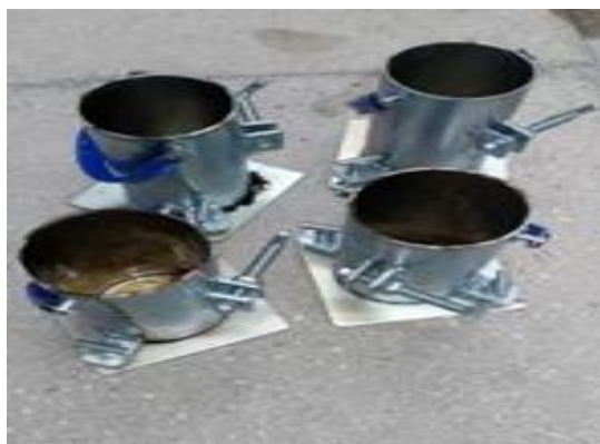
Figura 5: Moldes metálicos lubrificados
