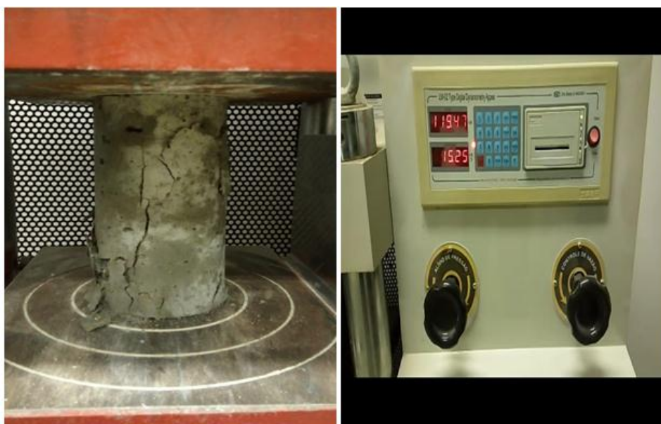
Figura 9: Prensa para ensaio de compressão
