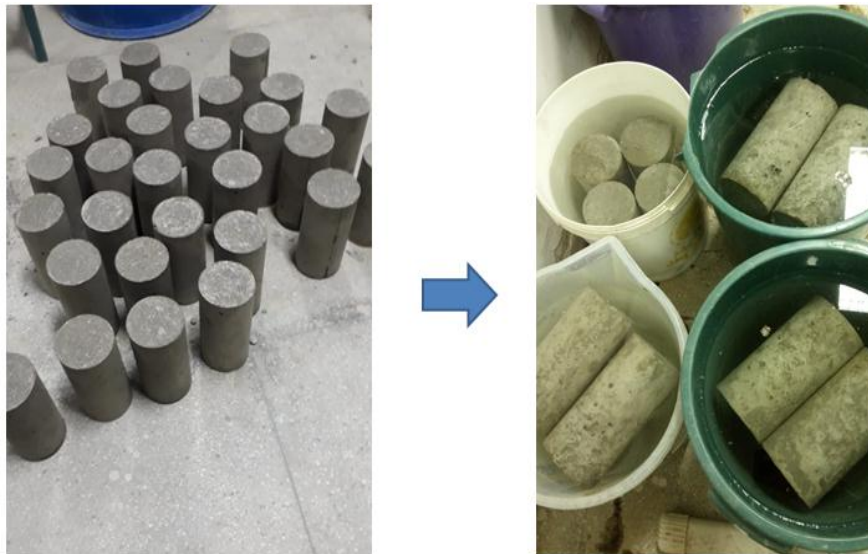
Figura 6: Corpos de prova e cura do concreto
