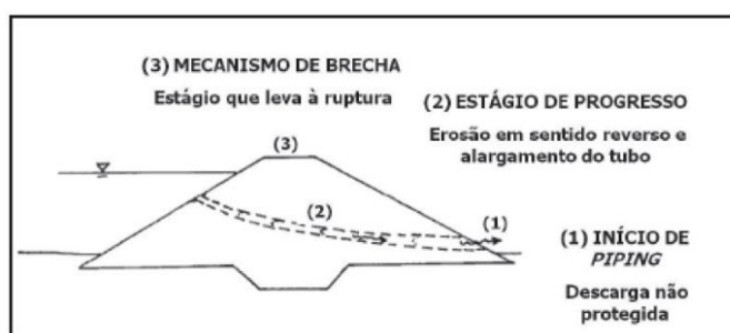
Figura 6: Processo de erosão interna, pipping.
