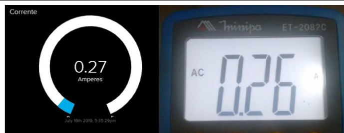
Figura 12. Valor de correntes obtido por multímetro e ACS712. (Autoria própria)
