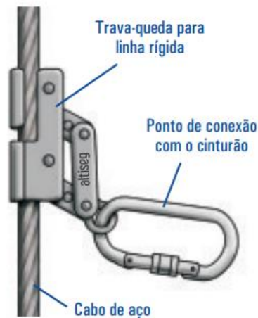
Figura 11: Esquema de trava queda para linha de vida rígida.
