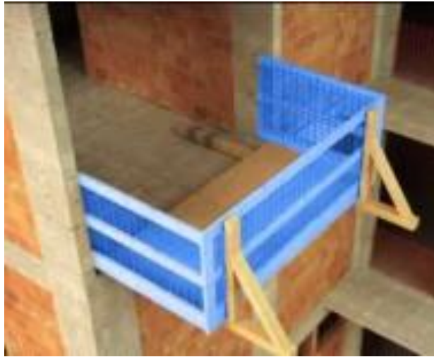
Figura 17: Modelo de andaime em balanço.
