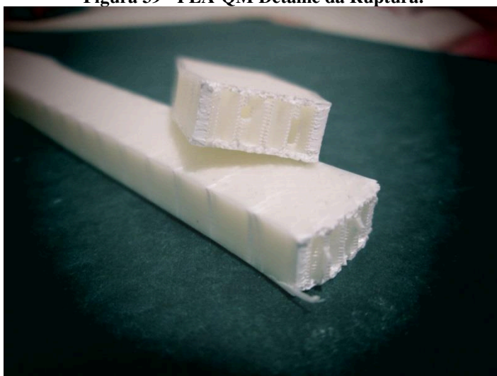
Figura 39 - PLA-QM Detalhe da Ruptura.
