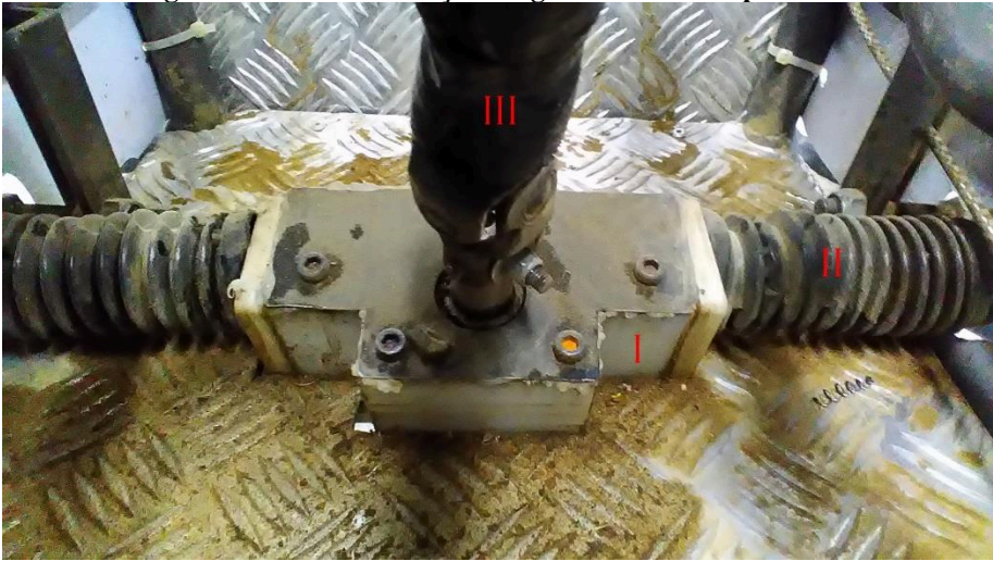
Figura 5 - Caixa de Direção e alguns de seus componentes.
