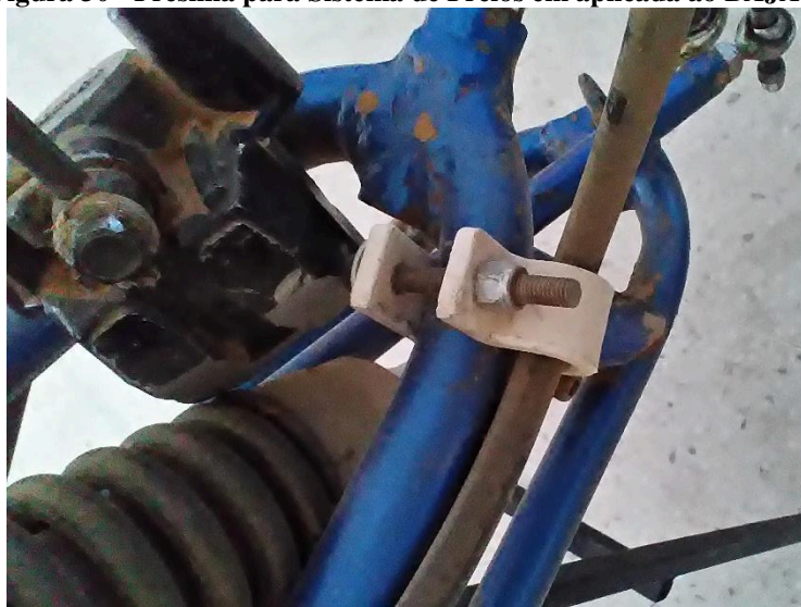
Figura 30 - Presilha para Sistema de Freios em aplicada ao BAJA 1.
