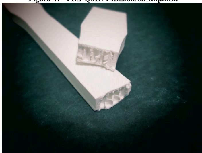
Figura 41 - PLA-QMC 1 Detalhe da Ruptura.
