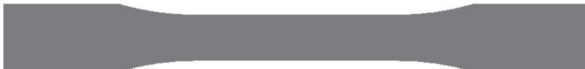
Figura 18 - Corpo de Prova-Tipo I.
