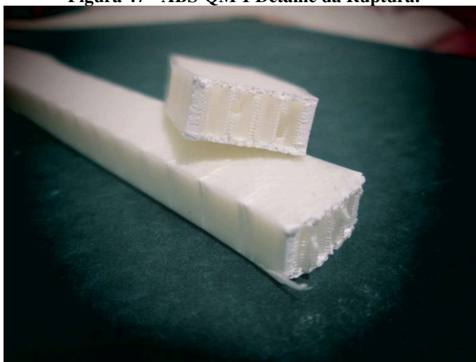
Figura 47 - ABS-QM 1 Detalhe da Ruptura.
