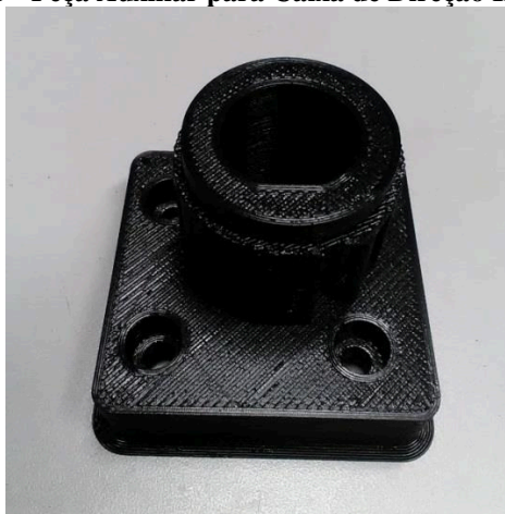
Figura 23 - Peça Auxiliar para Caixa de Direção Impressa 1.
