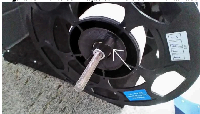
Figura 53 - Ponto de Fixação com Rolo de PLA encaixado.
