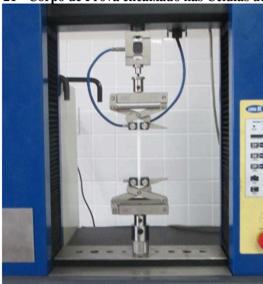
Figura 21 - Corpo de Prova encaixado nas Células de Carga.
