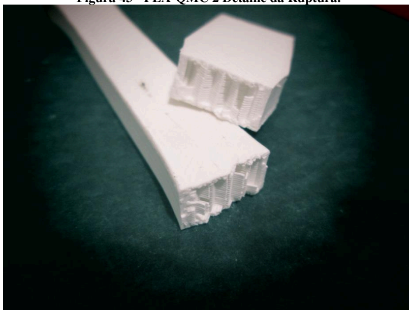
Figura 43 - PLA-QMC 2 Detalhe da Ruptura.
