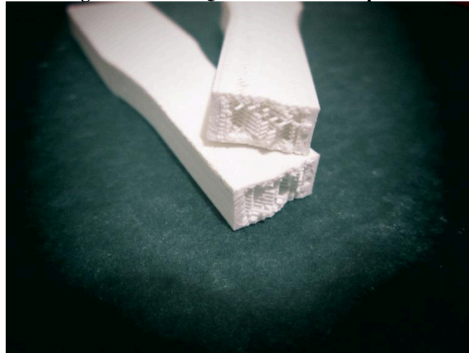
Figura 49 - ABS-QM 2 Detalhe da Ruptura.
