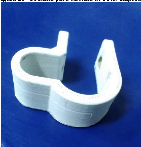
Figura 26 - Presilha para Sistema de Freio Impressa.
