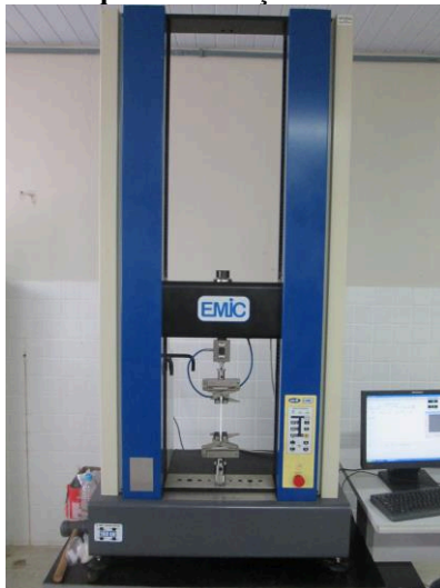
Figura 20 - Máquina de Tração e Células de Carga.
