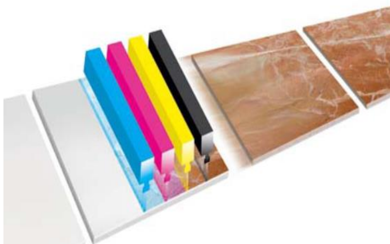
Figura 7 - Representação da impressão jato de tinta em placas cerâmicas.
