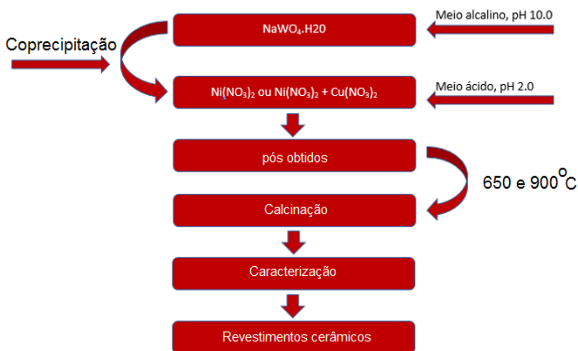
Figura 14 - Procedimentos para obtenção dos pós pelo método de coprecipitação química.
