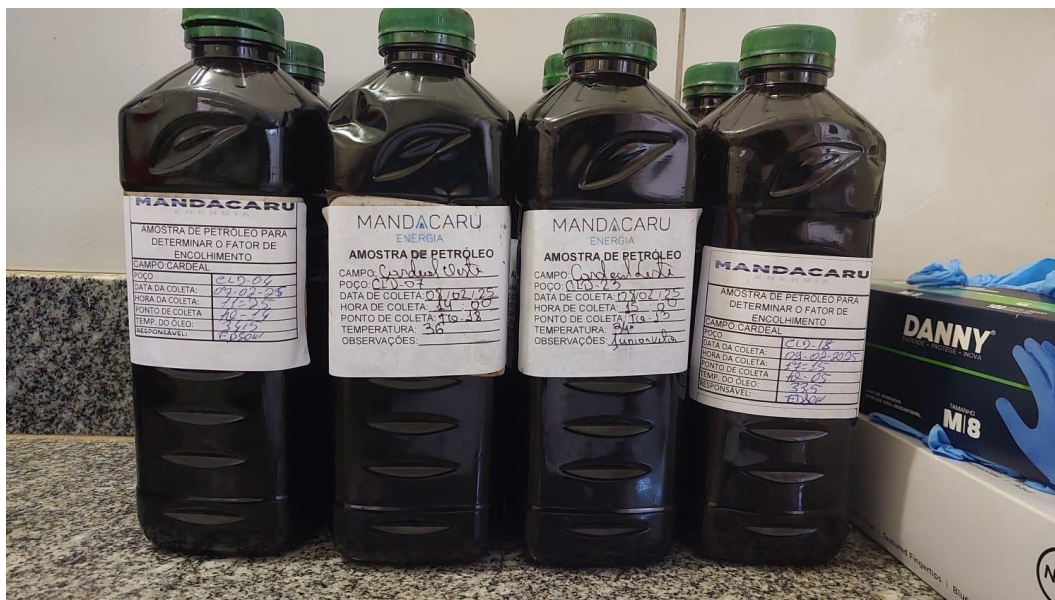
Figura 4 - Amostragem do óleo dos poços em garrafas para análise.
