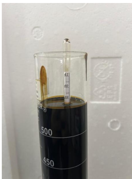
Figura 6 - Grau API aferido fazendo uso de um termodensímetro.
