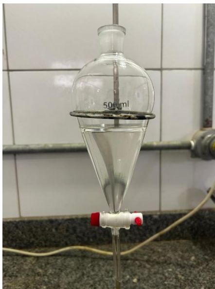
Figura 10 - Amostra e solvente colocados no funil.
