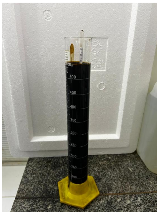
Figura 5 - Proveta com óleo para análise de API.
