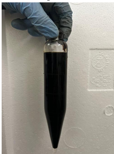
Figura 7 - Tubo de centrífuga com amostra de óleo para BSW.
