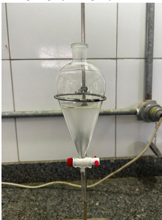
Figura 11 - Amostra após agitação e separação dos óleo e graxas da água.
