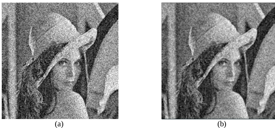
Figura 9 - Uma aplicação de passa-baixa de média. Em (a) uma imagem de lena com efeito sal e pimenta. Em (b) uma imagem de lena suavizada com máscara da media 3x3.
