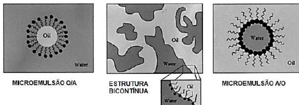
Figura 6. Representação esquemática dos tipos de microemulsões: microemulsão O/A, estrutura bicontínua e microemulsão A/O (Fonte: LAWRENCE; REES, 2012).
