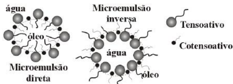
Figura 7. Estrutura de microemulsão direta (O/A) e inversa (A/O) (Fonte: NÓBREGA, 2007).
