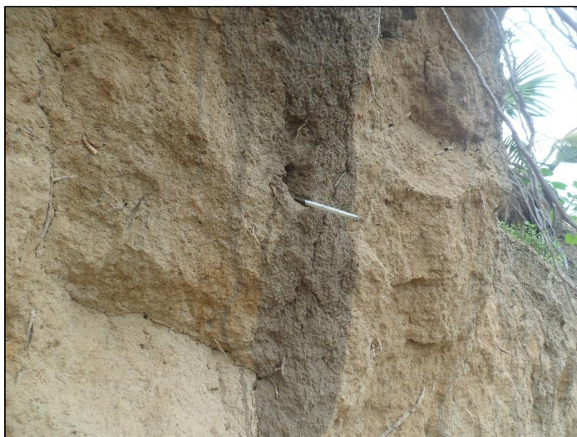
Figura 16 – Pino introduzido na margem e com exposição padrão de 10 cm.
