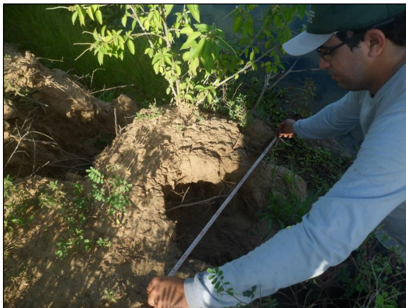
Figura 18 – Monitoramento do recuo dos pinos.
