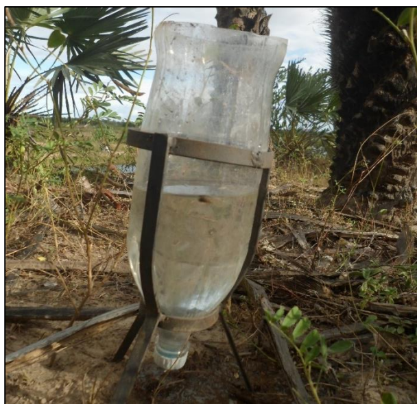
Figura 20 - Suporte utilizado na aplicação do teste de infiltração proposto por Maia (2014).
