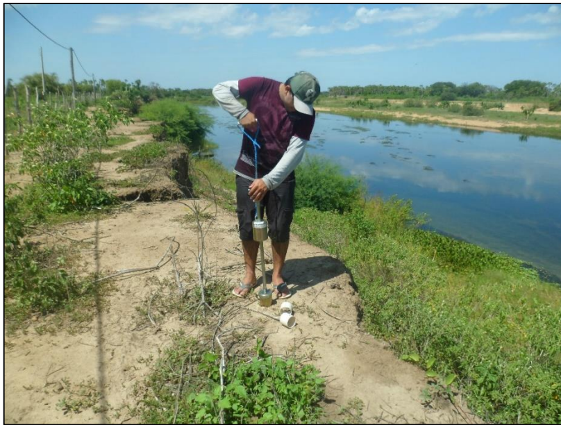
Figura 19 - Coleta de solo utilizando o Trado Urland.
