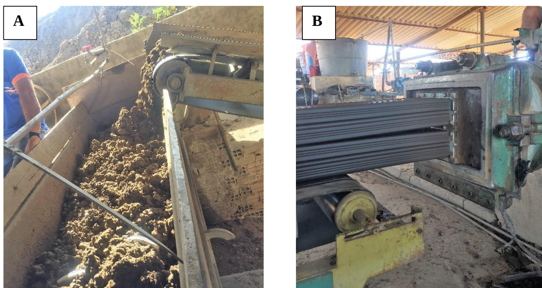
Figura 11 – Processo de moldagem: A) laminação e B) extrusão.
