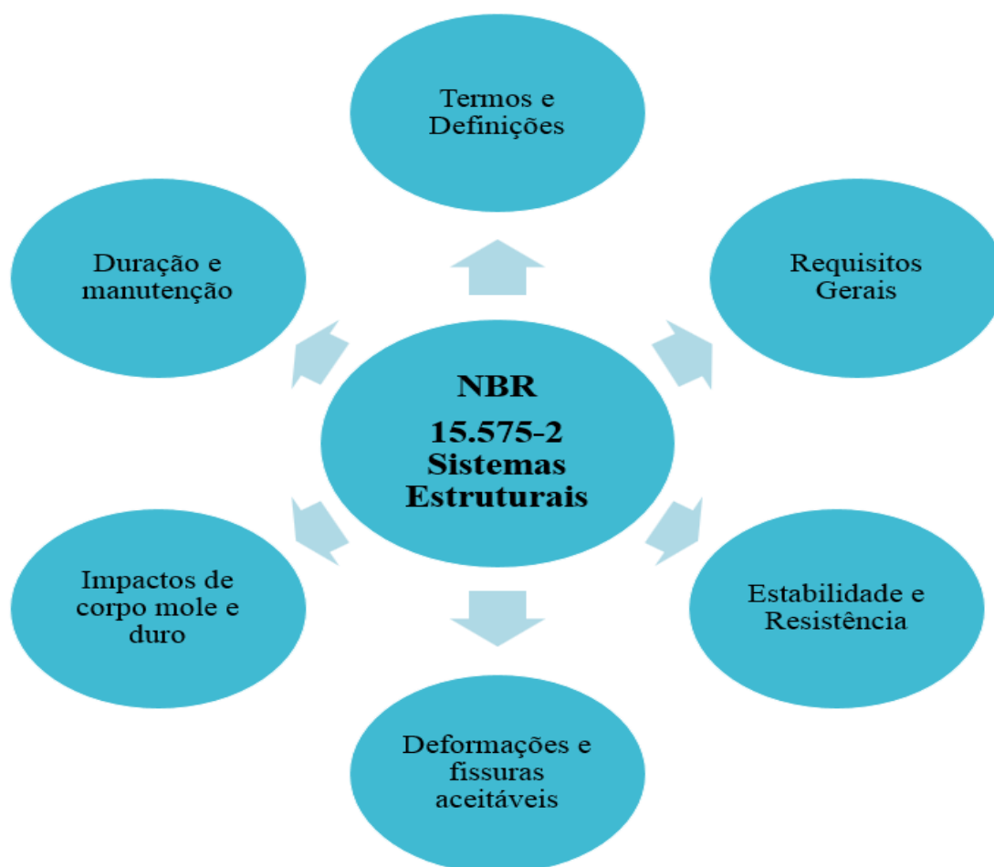
Figura 3 - Principais aspectos da NBR 15575 – 2 Sistemas Estruturais.
