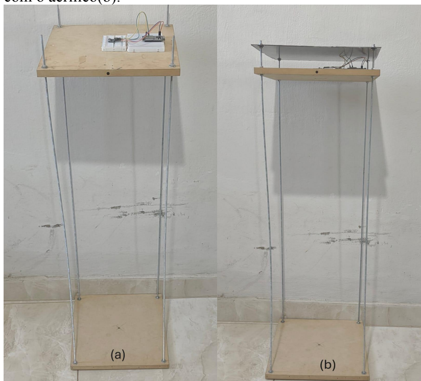
Figura 5 – Torre de oscilação montada com o sensor e Esp32 no topo(a) e montagem com o acrílico(b).
