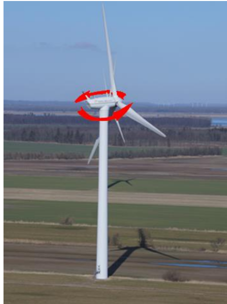
Figura 1.4: Ângulo guinada (yaw) de uma turbina eólica 2 .
