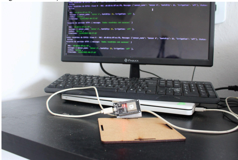
Figura 13 – Estação (ESP32 central) conectada via USB ao servidor caseiro
