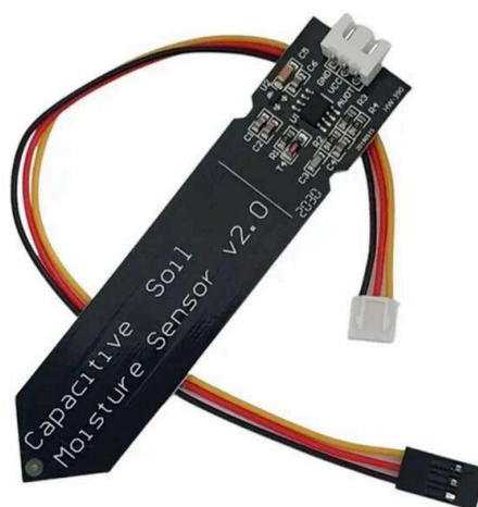
Figura 4 – Sensor de solo capacitivo
