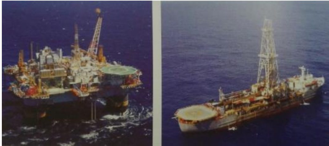
Figura 3 - Plataforma semissubmersível e navio sonda
