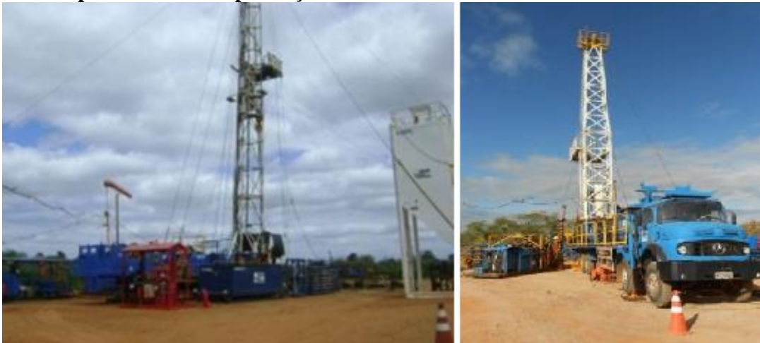
Figura 4 - Tipos de sonda de produção terrestre
