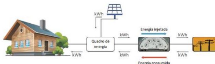
Figura 17 - Sistema de compensação de energia elétrica.
