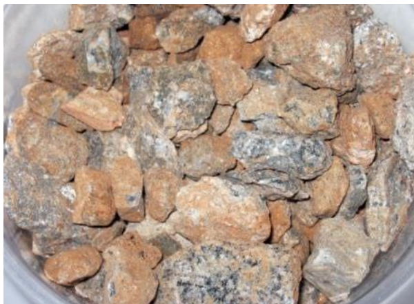
Figura 1- Aspecto visual de agregados reciclados de entulho de construção e demolição.
