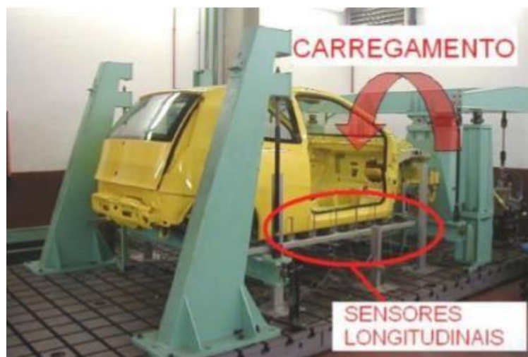
Figura 14: Teste experimental de rigidez torcional, feito pela FIAT
