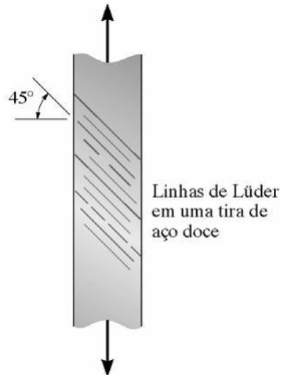
Figura 2: Escoamento do aço submetido a esforços axiais
