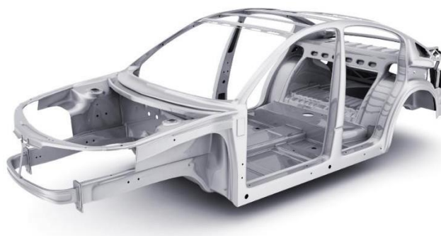
Figura 4: Chassi do tipo monobloco
