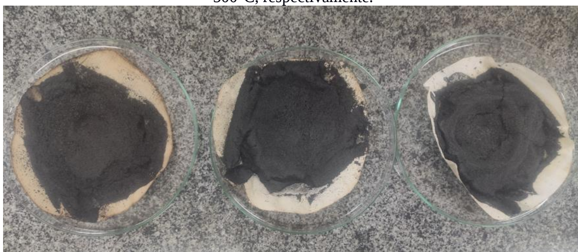
Figura 5 - Carvão ativado de inflorescência de macambira pirolisado a 400, 450 e 500^\circ C , respectivamente.
