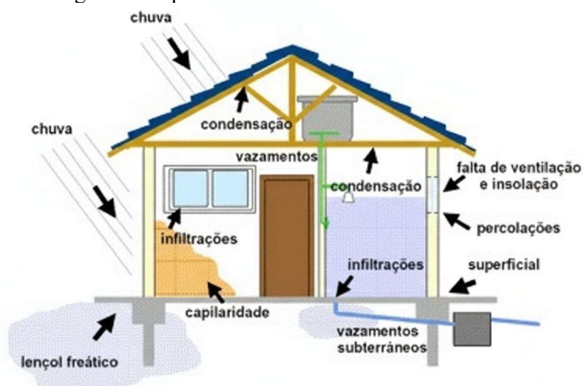
Figura 1 - Tipos de umidade em residência.
