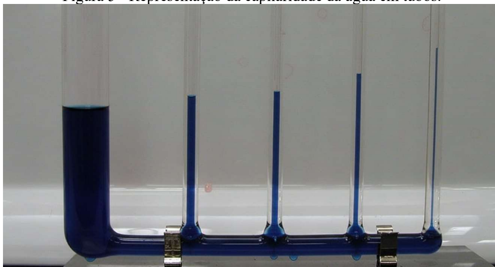
Figura 5 - Representação da capilaridade da água em tubos.
