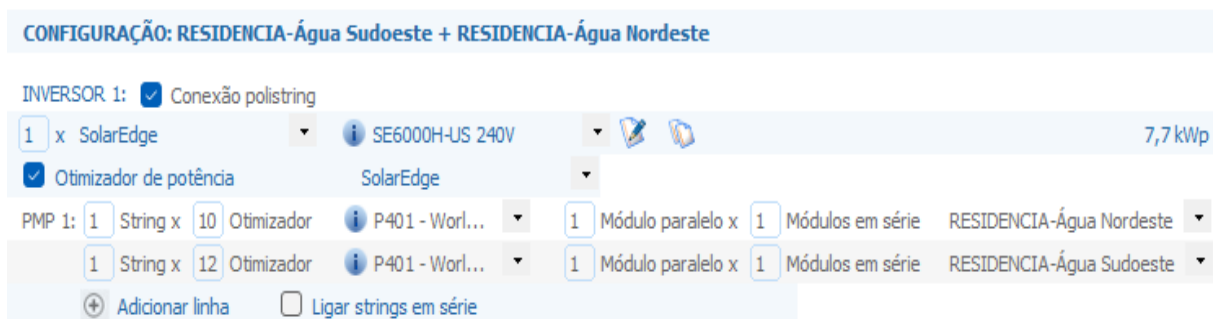
Figura 23 – Equipamentos usados no sistema com otimizadores de potência.
