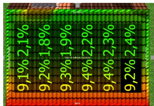
Figura 17 - Sombreamento telhado Sudoeste
