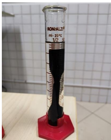
Figura 4. Corpo de prova de tração imergido em búle.
