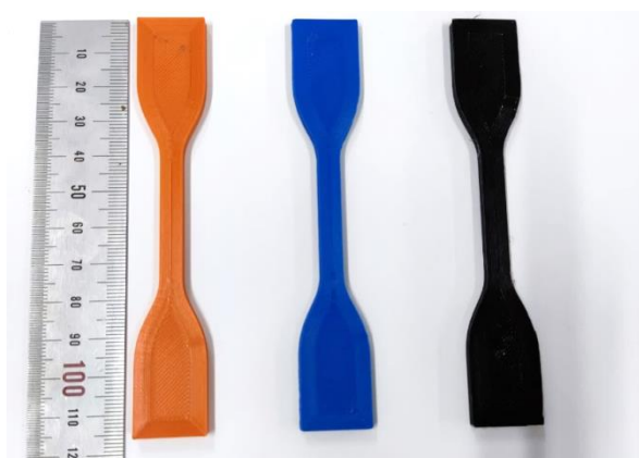
Figura 5. Corpos de prova (PLA, ABS e PETG, em ordem da esquerda para a direita) confeccionados para ensaio de tração.
