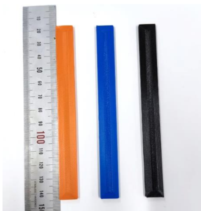
Figura 6. Amostra dos corpos de prova de flexão (PLA, ABS e PETG na ordem da esquerda para a direita).
