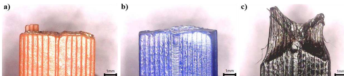
Figura 15. Imagem microscópica obtida das fraturas dos corpos de prova de tração ensaiados. São representados os materiais (a) PLA; (b) ABS e (c) PETG.
