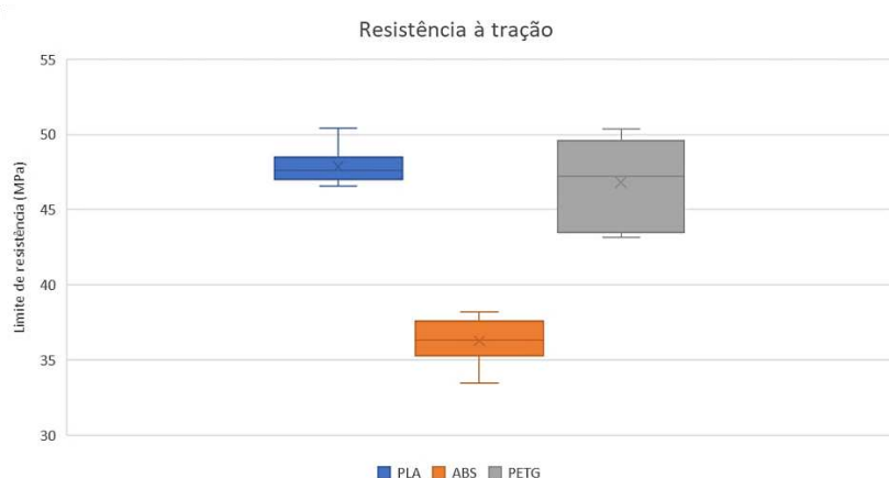
Figura 10. Comparação entre os limites de resistência à tração do PLA, ABS e PETG.
