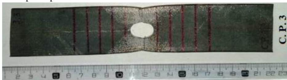
Figura 20 - Corpo de prova fraturado – amostra C.P. 3.
