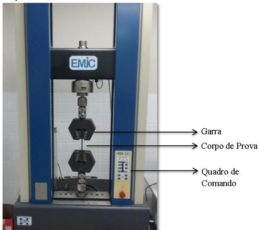
Figura 16 - Máquina Universal de Ensaio EMIC do laboratório da UFERSA.
