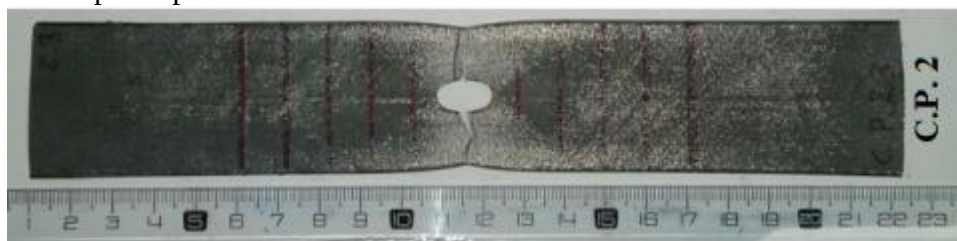
Figura 19 - Corpo de prova fraturado – amostra C.P. 2.
