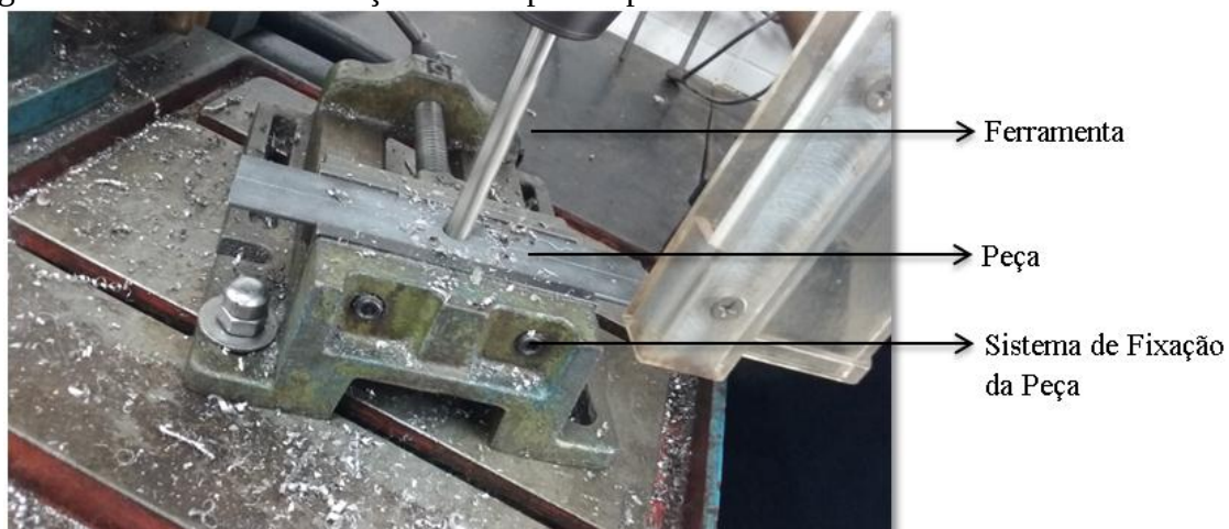
Figura 13 - Processo de furação dos corpos de prova.
