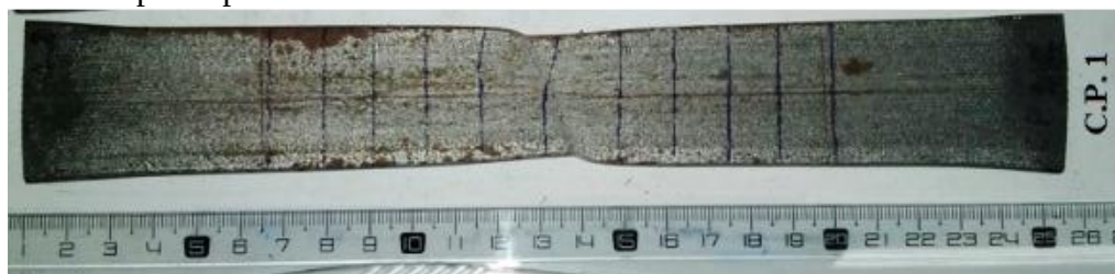
Figura 18 - Corpo de prova fraturado – amostra C.P. 1.
