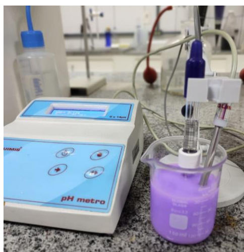
Figura 4 – pHmetro de bancada medindo o pH do desinfetante.
