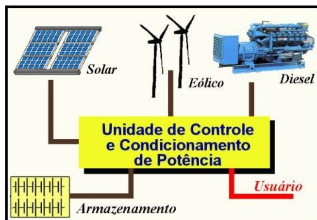
Figura 18: Composição de um sistema híbrido
