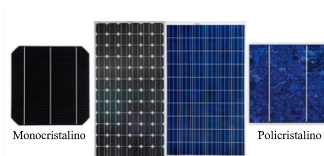
Figura 8: Célula e módulo fotovoltaico monocristalino e policristalino
