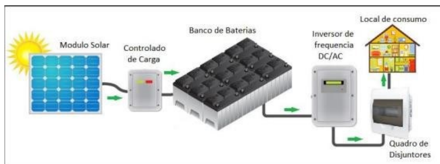
Figura 17: Composição de um sistema off grid
