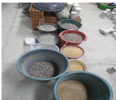
Figura 13 - Materiais para a confecção do concreto
