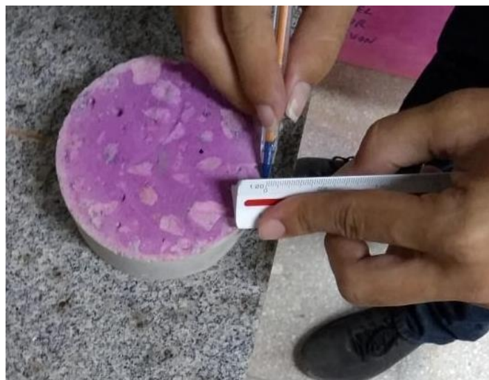
Figura 20 - Carbonatação no T10%
