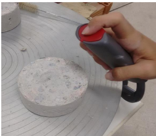
Figura 16– Aplicação da Fenolftaleína no concreto.
