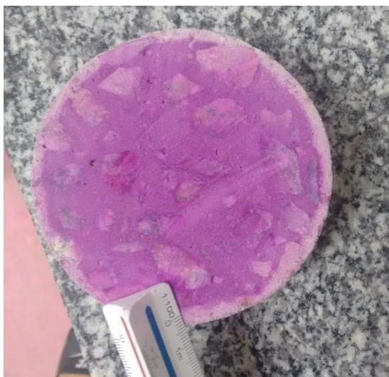
Figura 24 - Carbonatação T10% 60 dias
