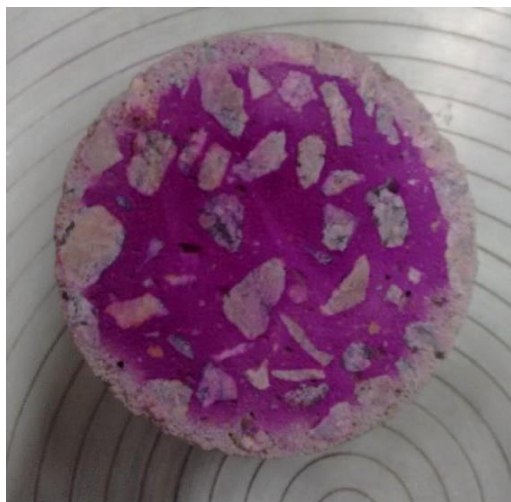
Figura 18- Carbonatação do T0%
