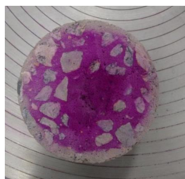
Figura 23 - Carbonatação T0% em 60 dias
