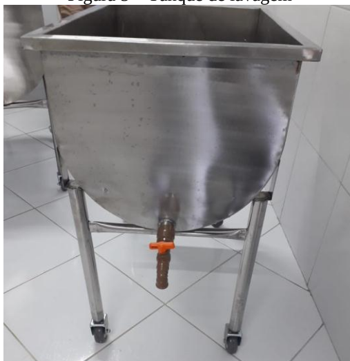
Figura 5 – Tanque de lavagem
