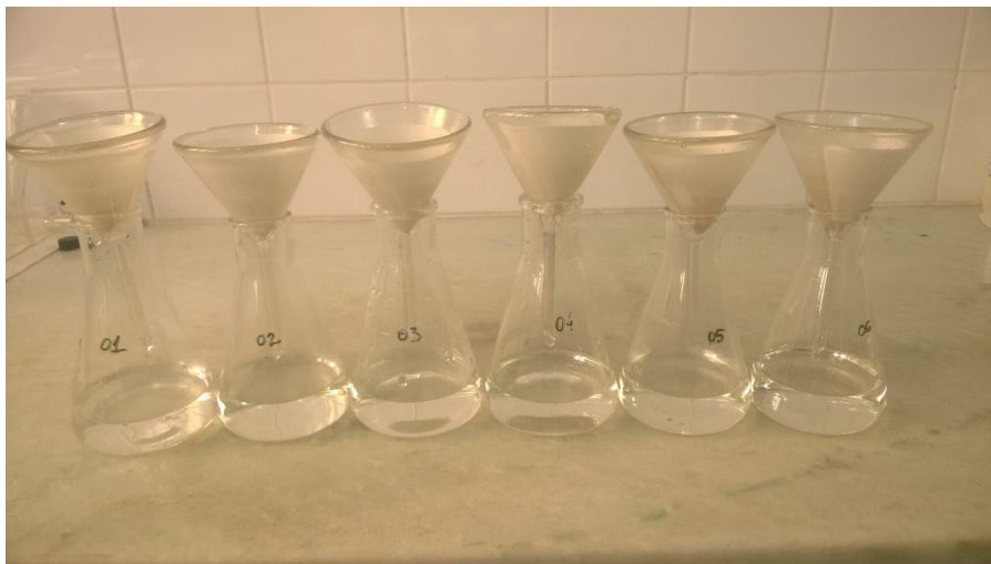
Figura 25 - Filtração da alíquota depois do Jar test
