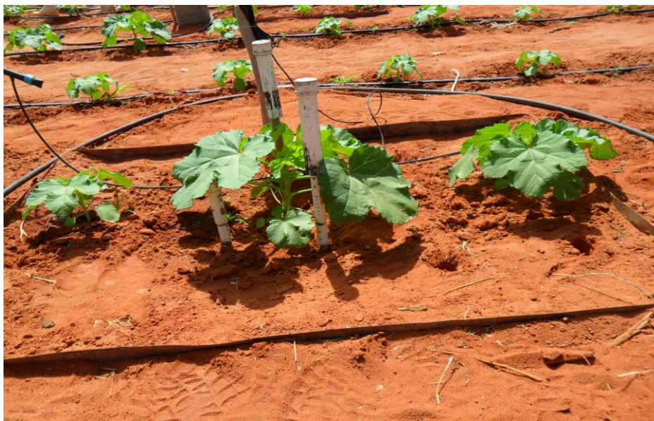
Figura 8. Localização da bateria de tensiômetros nas profundidades de 12,5; 37,5 e 62,5 cm, utilizada para medir a tensão de água no solo no período de 30 a 90 DAS da cultura de quiabo, cultivar Santa Cruz 47. Mossoró-RN, 2013.
