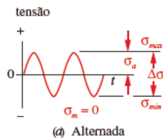
Figura 17- Tensões cíclicas alternadas, repetidas e pulsantes.
