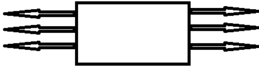
Figura 16- Placa retangular submetida a tensões cíclicas de tração na longitudinal.
