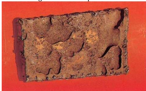
Figura 2: Corrosão por Placas
